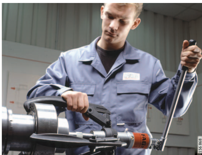
Figura 1 Smontaggio di un cuscinetto con estrattore idraulico
