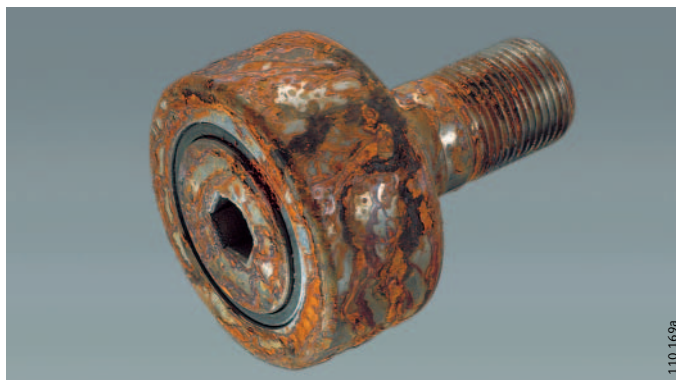
Figura 26 NUKR52 senza rivestimento dopo il test in nebbia salina
